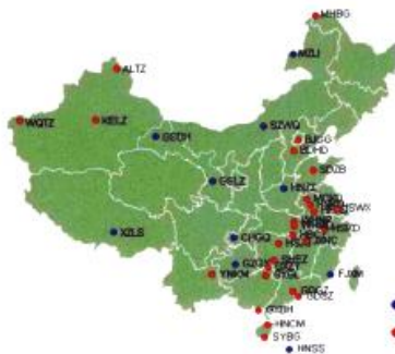
▲ 图3 中国GNSS电离层观测网站分布图。GNSS是Global Navigation Satellite System的缩写，意指全球导航卫星系统。目前，GNSS包含了美国的GPS、中国的Compass（北斗）、俄罗斯的GLONASS和欧盟的Galileo系统。GNSS信号的伪距和载波相位等数据与电离层电子总含量等密切相关，在电离层科学研究和工程应用上有重要的意义。（注：图中蓝点为规划站点，红色为已建站点。）
